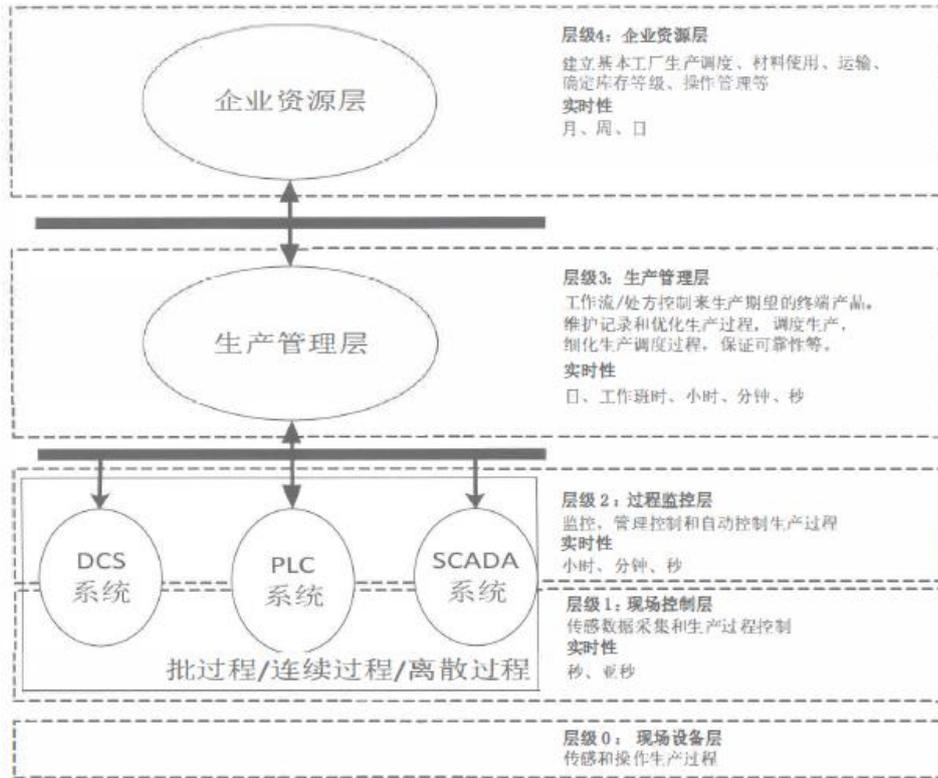
注：该图为工业控制系统经典层次模型参考 IEC 62264-1,但随着工业 4.0、信息物理系统的发展,已不能完全适用,因此对于不同的行业企业实际发展情况,允许部分层级合并。
