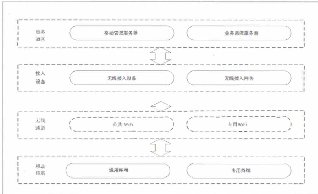
图 E.1 移动互联应用架构
